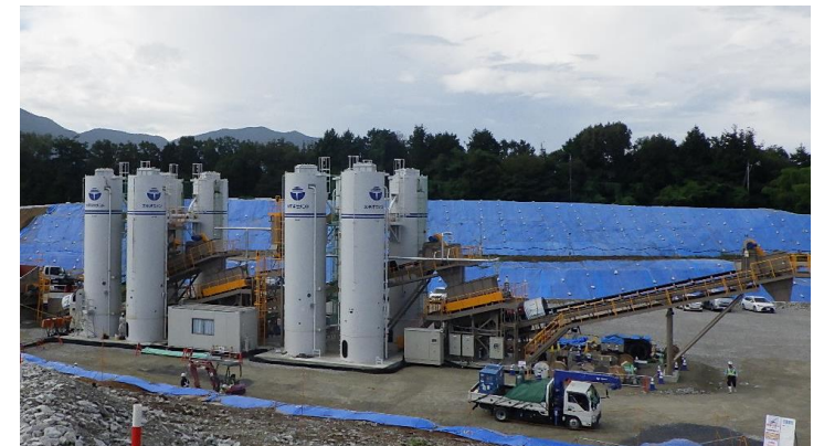
解砕・分級・混合一体型多軸スクリーン設備
