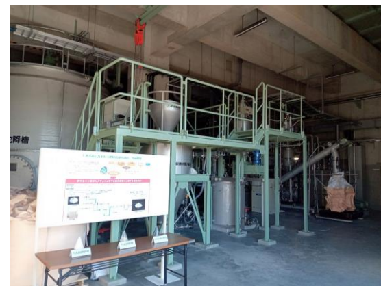
リン回収・肥料化施設（B-DASHプロジェクト）
