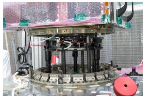
ドッキングプレート非搭載物体の捕獲機構 (ADR)
