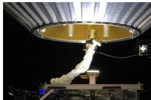
メカニカルアームによるGEO衛星捕獲 (LEX)
