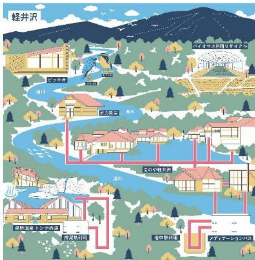
地中熱や温泉排熱を空調や給湯の熱源にするヒートポンプ設備
