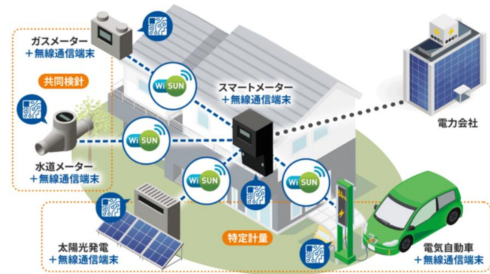
図1 IoTルートの利用イメージ (図内の無線端末にWi-SUN enhanced HANが搭載され、電力スマートメーターと接続)
