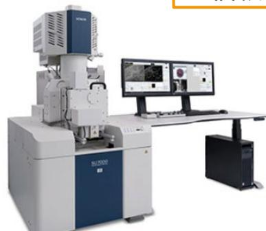
超高分解能電子顕微鏡
