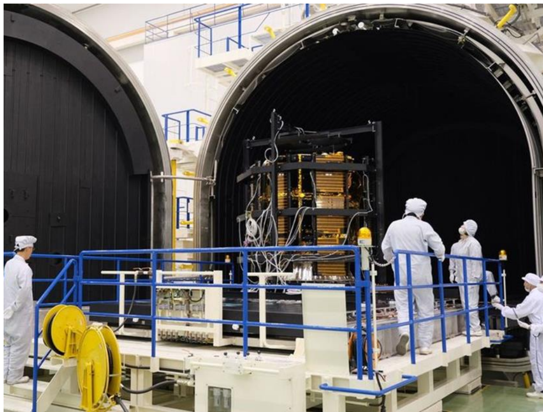
筑波にあるJAXA設備にて、ispaceエンジニアがRESILIENCEランダーを大型チャンバー（真空と熱環境を模擬した環境）に移動する様子
