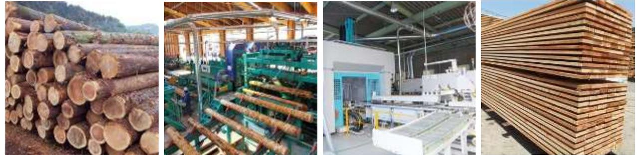
原木から製材し、プレカット加工を経て出荷へ。
