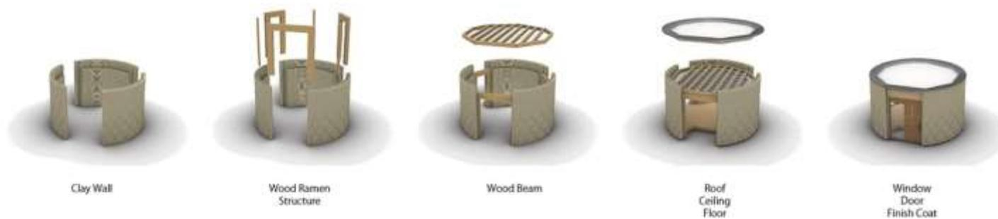
壁のプリント 約72時間 + 木軸工事 約8時間 + 屋根工事 約16時間
