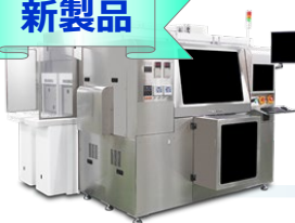
ハイエンドウェーハレベル パッケージボンダ TFC-6600 FO-WLP、APEモジュール
