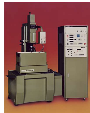
現存最古級のマイコンNC搭載形彫り放電加工機「22-NC 8000」(1980年)
