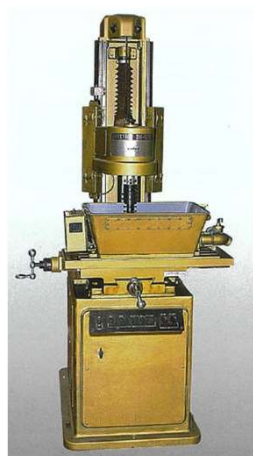
日本初の实用形彫り放電加工機「Japaxtron D3」(1954年)
