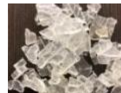
割れパネルのガラス
