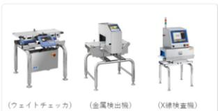
ウェイトチェッカは従来製品より計量精度が60%以上向上し、生産現場での歩留まり改善や省エネに貢献。金属検出機、X線検査機は混入異物製品を検査・選別することにより、市場流通品の回収・廃棄によるフードロスの削減に貢献
