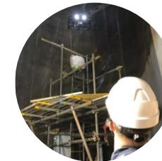
ドローンを用いて超音波で板厚を計測人の高所作業を削減
