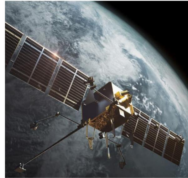
サービサーを使用し、燃料枯渇した衛星を捕獲、姿勢維持や燃料補給、軌道修正や別軌道へ移動を実施
