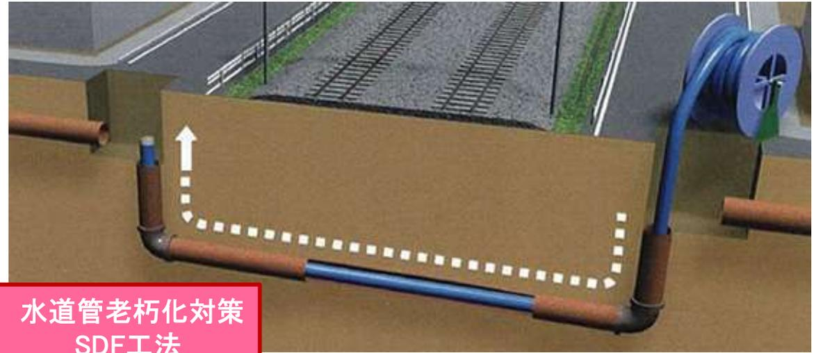
SDF工法向けにフレキ管を供給
