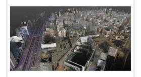
MMS(モバイルマッピングシステム)は、車両等で移動しながら高精度な3次元計測を行うシステムです。車両や船舶、鉄道等の移動体に3Dレーザースキャナを搭載して計測することにより、広範囲を効率良く高精度・高密度に計測が可能です。
