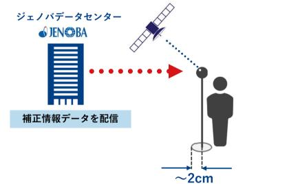
測位衛星からの信号と、補正情報データを解析し、高精度 に位置を求めることができます。
