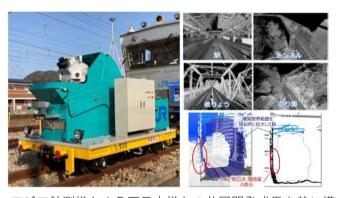
アジア航測様とJR西日本様との共同開発成果を基に構築された鉄道MMS計測・解析・システムのサービス「RaiLis」では、鉄道事業者向けに最先端の3次元空間情報計測・解析技術を提供しています。位置情報解析にあたり、当社の後処理データサービスが利用されております。本システムの導入により、線路周辺の3次元情報を効率良く取得でき、さらには、線路内立入作業時間の短縮、省力化による保安度の向上、現場状況把握など、高品質で効率的な運用業務を行うことが可能。調査・測定作業を効率化・高精度化することで、鉄道事業が抱える様々な課題解決に貢献しております。
