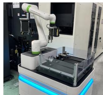
工具交換・運搬用AGV
