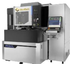
リニアモータ駆動 超精密 ワイヤ放電加工機
