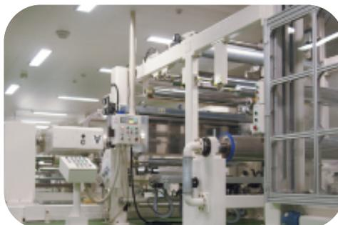
高度な技術を駆使した高機能な塗工液が開発されても、フィルム上で期待された性能を発揮できなければ製品にはなりません。フジコピアンには、必要な塗工液を必要なだけ高精度に塗工する高精度塗工技術があります。塗工液にもっとも適した塗工方式、塗工条件を選択し、必要とされる機能をもつ塗膜を効率よく形成。異なった機能を持つ塗膜を何層にも重ねることにより、より高度な機能を持たせる積層塗工ができるのも、この高精度塗工技術があればこそです。
