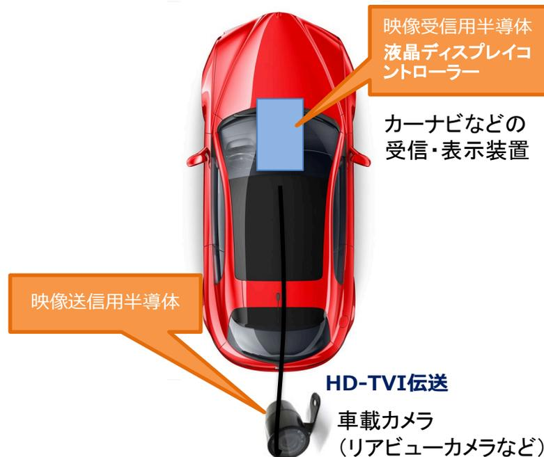
映像の送受信にはアナログ方式とIP (デジタル) 方式に大別されますが、当社は普及済みのアナログ用配線を用いることで安価ながらも高画質映像 (HDから4K画質まで) の送受信を可能にするHD-TVI規格の伝送技術を有し、それを用いた当社半導体製品は監視カメラ・DVRメーカーおよび車載のドライブレコーダー・車載カメラ・カーナビメーカー等に採用いただいています。
