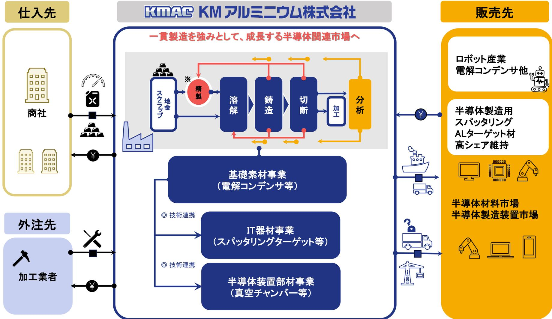
※精製(純化)技術・・・偏析法の一つであるペシネー法により、アルミニウムの純度を上げる世界でも有数の技術。
