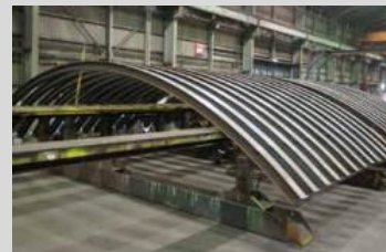
トンネル支保工
