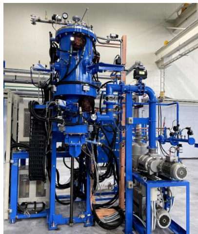
二次電池素材熱処理設備
