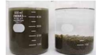
伯東独自の排水処理用薬剤「ハクトロン」は汚染水の一次処理に使用することで、蒸留装置の運用効率が向上(写真左から処理前、処理後)
