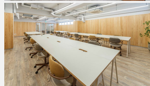
写真：U square 四谷三丁目内観。セットアップオフィス化に伴い、照明のLED化、人感センサーによる自動減光方式の導入、床面積・用途に適した空調・換気機器の選定を実施
