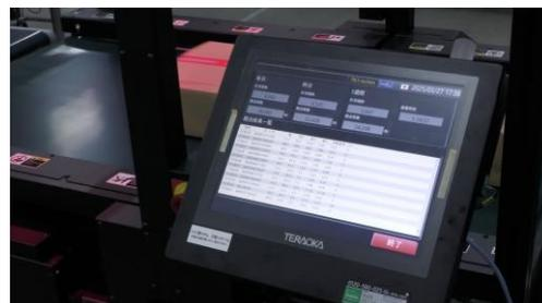
荷物のサイズ、重さを全自動計測する
