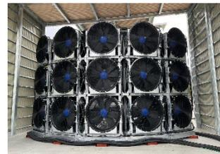
飛行中に受けるさまざまな荷重を模擬し、ローターやモーターの耐久性を評価する「**耐久風洞設備**」 ©SkyDrive
