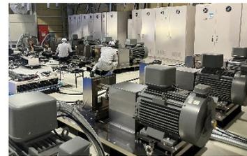
シミュレーターと連動しながら負荷をコントロールすることで、ベンチ上でさまざまな模擬飛行を実施できる**当社製「電動推進システム評価ベンチ」**
