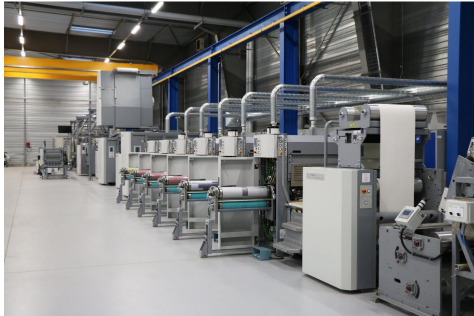
印刷～後加工までをワンパスで実現するKCM機
